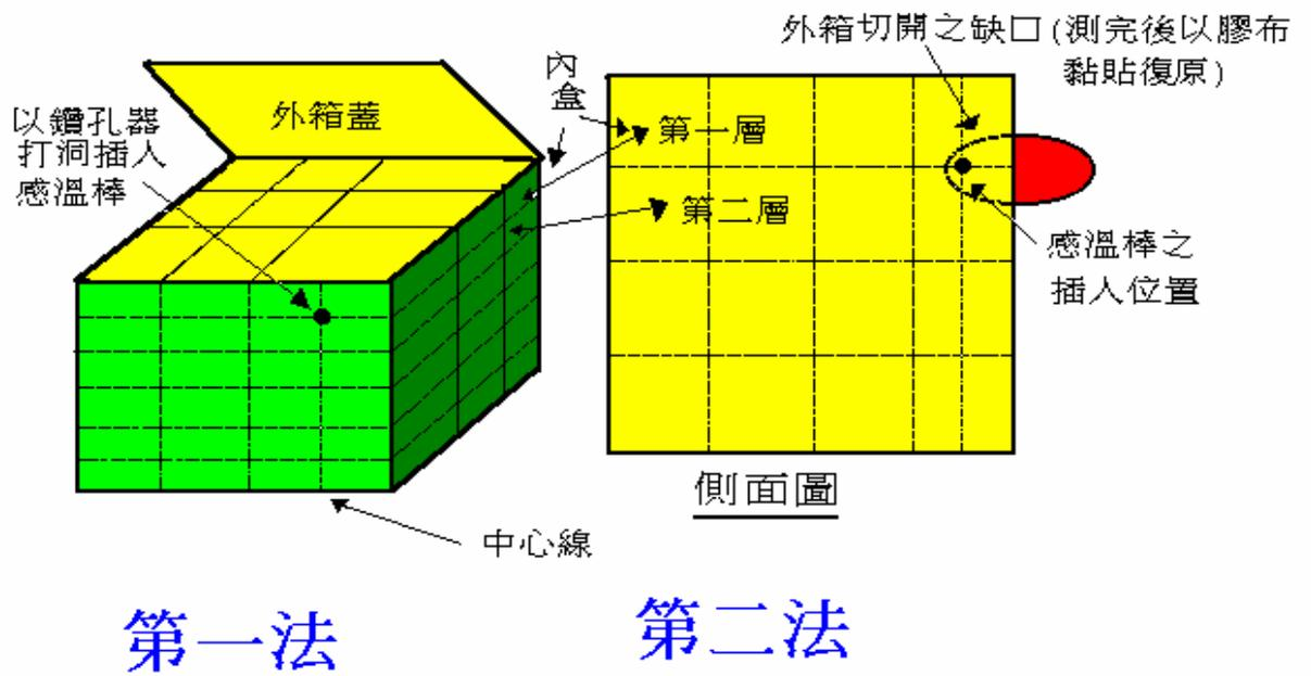
圖3：冷凍食品之品溫測定方法
